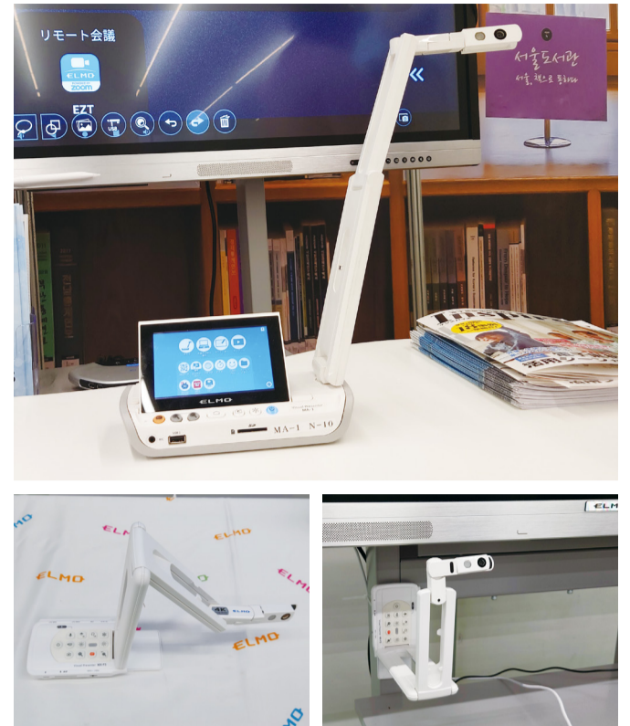
④完全ワイヤレス可動式書画カメラMA-1 ⑤モバイル書画カメラMX-P3 ⑥⑦本体底部のマグネットを使えば黒板などに固定できる
